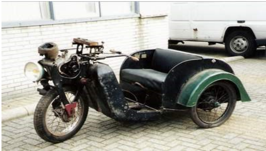
Alcyon Mototri uit 1934, oorspronkelijk met een Zurcher 175 cc tweetakt blok, later is er een Gnome & Rhône 250 cc zijklep blok op gemonteerd
