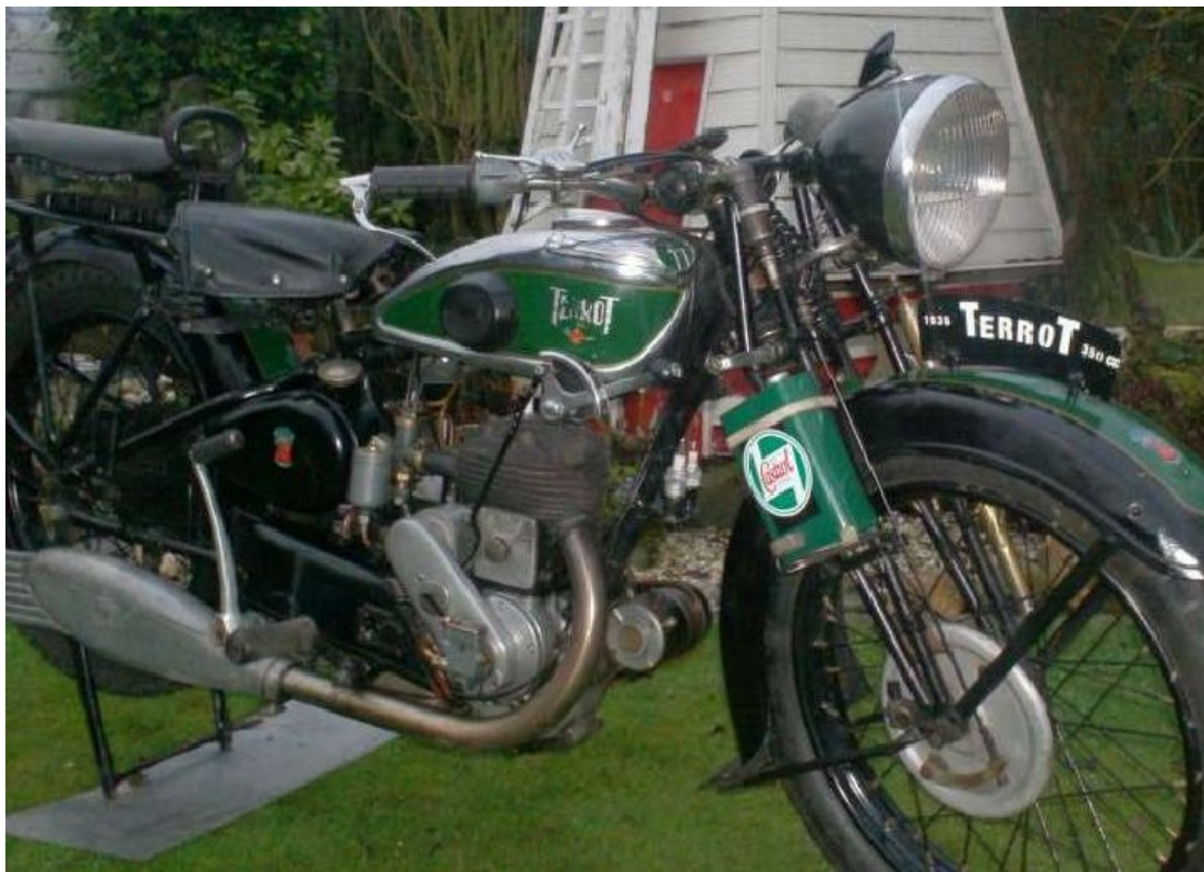
De Terrot HD van Jan Reyners uit 1936: 350 cc zijklepper, aluminium uitlaat, oliebliek, kortom: een fraaie motor
